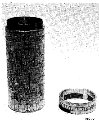
Fig. 1. De tijd-draaibus van PAOWRL. De 'tijdzone-ring' is voor de duidelijkheid even naast de bus gelegd. (Foto PE1ADA)
